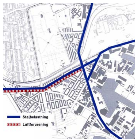
Kort 6.12: Udvalgte veje i Kgs. Enghave hvor grænseværdierne for luftforurening og støjbelastning overskrides 12 . Grænseværdien for udendørs støj er 65 dB (A). Grænseværdien for kvælstofdioxid (NO 2 ) er 135 milligram pr. kubikmeter. (Vej & Park, 2000).
